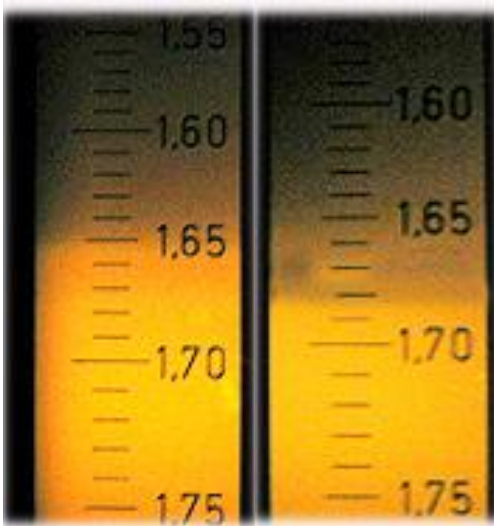
Refraktometrets aflæsningskala ved brug af polariseringsfilter.
